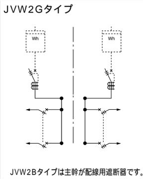
**電灯/単3** **動力/3相** 主幹:漏電遮断器・配線用遮断器 (電灯回路:単3中性線欠相保護付) **WHMスペース付×2**
