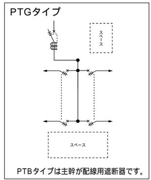
**3相** 主幹：漏電遮断器・配線用遮断器 送りスペース付 下部スペース(400mm)付
