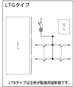
**単3** 主幹：単3中性線欠相保護付 漏電遮断器・配線用遮断器 送りスペース付 動力スペース付
