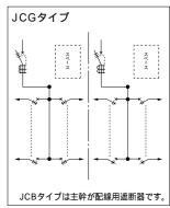
主幹:漏電遮断器·配線用遮断器 (電灯回路:単3中性線欠相保護付)
