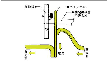
構造は図のようになっております。電流は、電源側からバイメタル、負荷側へと流れます。
