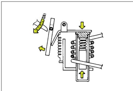
過電流がコイルに流れますと可動鉄心が固定鉄心の方へ吸引されます。吸引されると磁気抵抗が減少し作動鉄片が吸引され作動板を動かし開閉機構部の係合端が外れ、これに連動し可動接点が開き回路を遮断します。
