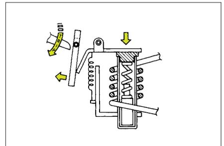
大電流がコイルに流れた場合は、可動鉄心の動きをまたず、瞬時に作動鉄片が吸引され作動板を動かします。
