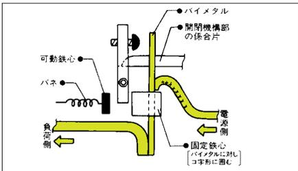
構造は図のようになっており電磁引外し素子の動作する電流値未満では、熱動形と全く同じ動作をします。
