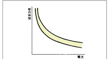
電流が大きければ、発熱量も多く、早くわん曲します。動作特性は図のように電流が増せば動作が早くなる反限時特性をもっています。
