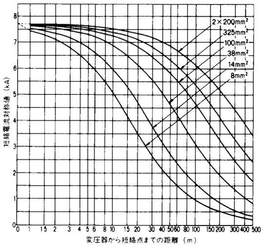
付図10 三相変圧器容量200kVA、二次電圧200V
