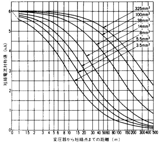
付図8 三相変圧器容量150kVA、二次電圧200V
