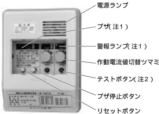
(注1)漏電発生時にブザ停止ボタンを押した場合、ブザは停止しますが、警報ランプは点灯を継続します。漏電がなくなれば、ブザは鳴りやみませんが、警報ランプは手動復帰形ですので、漏電箇所復帰後は必ずリセットボタンを押して復帰させてください。
