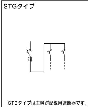
主幹：漏電遮断器・配線用遮断器      分岐：配線用遮断器 × 2 (屋内用)
