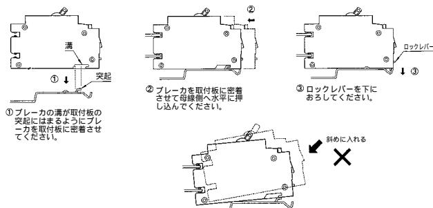
【注意】ブレーカの溝に取付板の突起がはまっている状態でブレーカを取り付けると、ブレーカが破損するおそれがあります。
