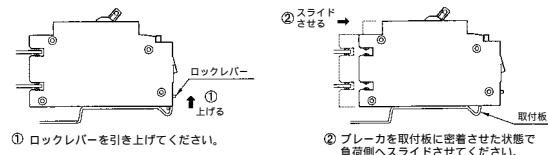
【注意】スライドさせずにブレーカの負荷側を無理に持ち上げるとブレーカが破損します。
