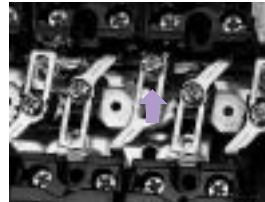
切替金具を200V側にスライドする。切替金具の接続ねじを締め付けて200Vへの切替え完了です。
