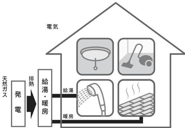
家庭用ガス発電・給湯暖房機のしくみと熱の利用先
