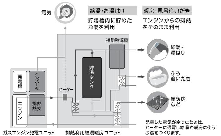
家庭用ガス発電・給湯暖房機用電気系統接続概要図
