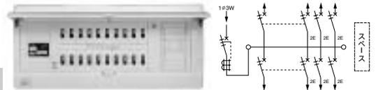
**単3** 主幹: 単3中性線欠相保護付漏電遮断器 付属機器取付スペース付 タテ ヨコ フカサ 180x90x45
