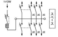
**単3** 主幹：単3中性線欠相保護付漏電遮断器 付属機器取付スペース付 タテ ヨコ フカサ 175x75x48
