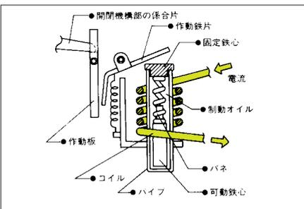
構造は図のようにパイプにコイルが巻かれており、このコイルに電流が流れます。
