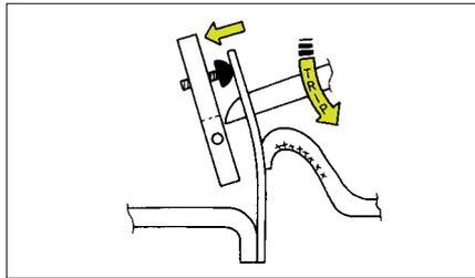
定格電流以上の電流が流れた場合、バイメタルが加熱され、わん曲しバイメタルの先端が作動板を押し開閉機構部の係合端が外れます。これに連動し可動接点が開き、回路を遮断します。
