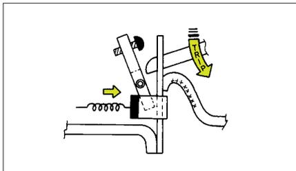
大電流が流れる際に、発生する磁界により可動鉄心と固定鉄心が吸引し合います。この時可動鉄心が作動板を押し開閉機構部の係合端が外れ、これに連動し可動接点が開き回路を遮断します。
