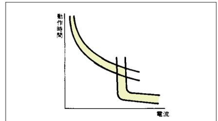
動作機構上、熱動動作(時延引外し)領域と電磁動作(瞬時引外し)領域の和で表されます。
