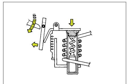
大電流がコイルに流れた場合は、可動鉄心の動きをまたず、瞬時に作動鉄片が吸引され作動板を動かします。
