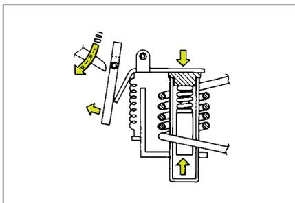
過電流がコイルに流れますと可動鉄心が固定鉄心の方へ吸引されます。吸引されると磁気抵抗が減少し作動鉄片が吸引され作動板を動かして開閉機構部の係合端が外れ、これに連動し可動接点が開き回路を遮断します。
