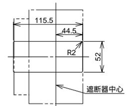
(遮断器の容積に対して片側1mmのすき間をもたせた場合です。表面形:取付面からの高さ 103mm 裏面形:取付面からの高さ 113mm)
