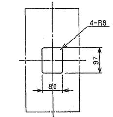
表板の高さは遮断器の底面より150mmの場合です。寸法は遮断器の窓枠に対して片側1mmの隙間をもたせた場合です。
