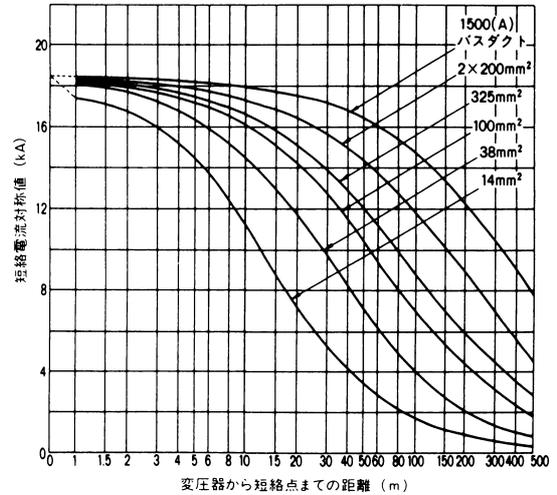
付図22 三相変圧器容量2000kVA、二次電圧200V
