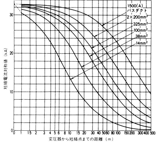
付図20 三相変圧器容量1500kVA、二次電圧200V
