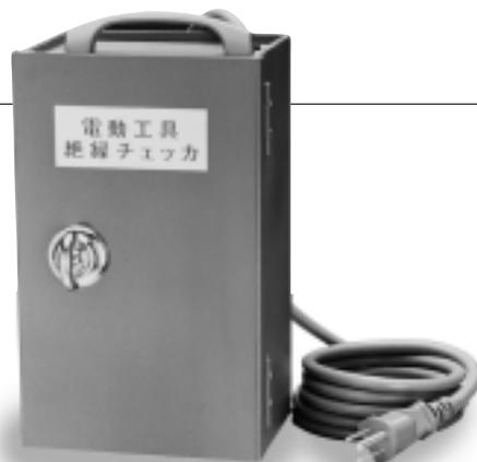
電動工具を実際に運転し絶縁状態がチェックできます。電動工具を実際に運転しますので正常運転かどうかの判定もできます。操作が簡単です。電動工具のプラグをMC-2EHの測定用コンセントへ差し込み電動工具を運転します。この時MC-2EHが動作すれば、その電動工具の絶縁状態は不良と判定されます。収納ケースは防じん形で丈夫なスチール製です。建設現場、機材センター等での電動工具の絶縁チェック、メンテナンスに最適です。
