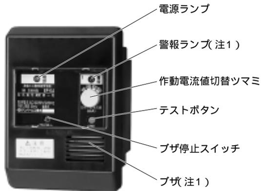
(注1) 漏電発生時にブザ停止スイッチを停止側にした場合、ブザは停止しますが、警報ランプは点灯を継続します。自動復帰形ですので、漏電がなくなれば、ブザは鳴りやみ、警報ランプも自動的に消灯します。
