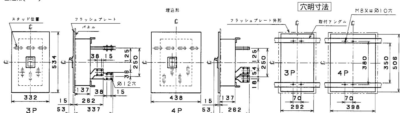
可調整部(過負荷警報表示灯、定格電流設定つまみ等)が露出する穴付きも御要求により製作します。
