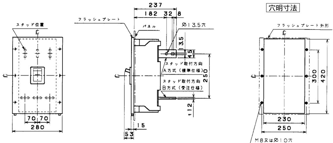
可調整部 (過負荷警報表示灯、定格電流設定つまみ等) が露出するバースタッド方向標準 (A方式) で出荷します。
