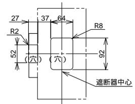
(遮断器の容枠に対して片側1mmのすき間をもたせた場合です。表面形:取付面からの高さ 103mm 裏面形:取付面からの高さ 113mm)
