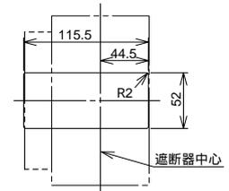
(遮断器の容枠に対して片側1mmのすき間をもたせた場合です。表面形:取付面からの高さ 103mm 裏面形:取付面からの高さ 113mm)
