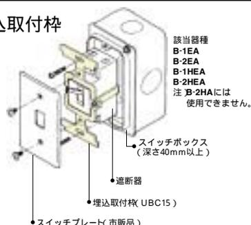
埋込取付枠は安全ブレーカをスイッチボックス(深形)に組込む場合に使用します。その場合プレートは、埋込タンブラスイッチプレートとボックスをお求めください。
