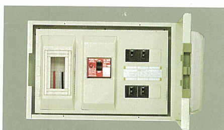
H325・W455・D100 露出形 〔主幹〕(ELCB) OC付 3P50A 100V↔200V相互切替可能 〔注〕主幹ELCB OCなし30A・OC付60Aも受注製作いたします。
